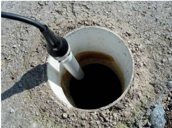
Sonda per la misurazione della temperatura del suolo.
