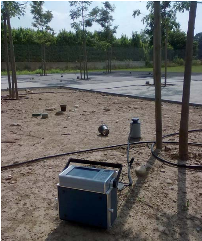
Misurazione della concentrazione di ossigeno e anidride carbonica nel suolo.
