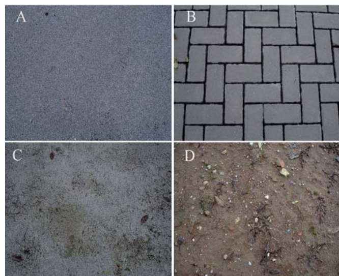
A: pavimentazione impermeabile (asfalto); B: pavimentazione permeabile (autobloccante); C: pavimentazione porosa; D: controllo: suolo non pavimentato.
